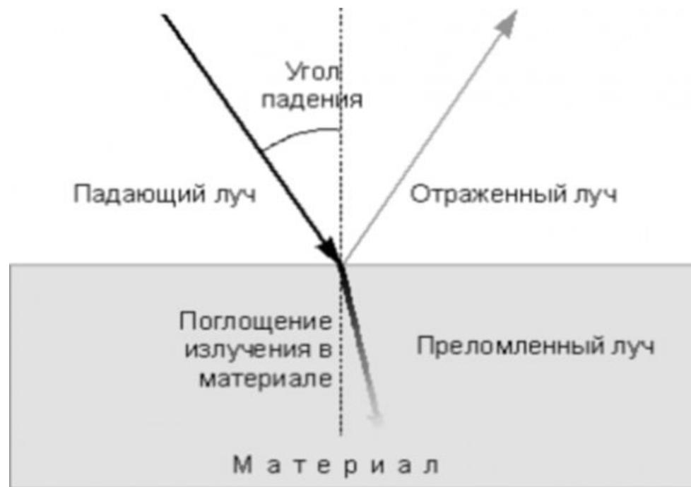
На первой стадии теплового воздействия лазерного излучения на материал, фазовое состояние твердого тела не успевает измениться. Основные явления в этом случае заключаются в отражении и поглощении излучения поверхностью, нагревании поверхности, распространении тепла в глубь среды за счет теплопроводности.
