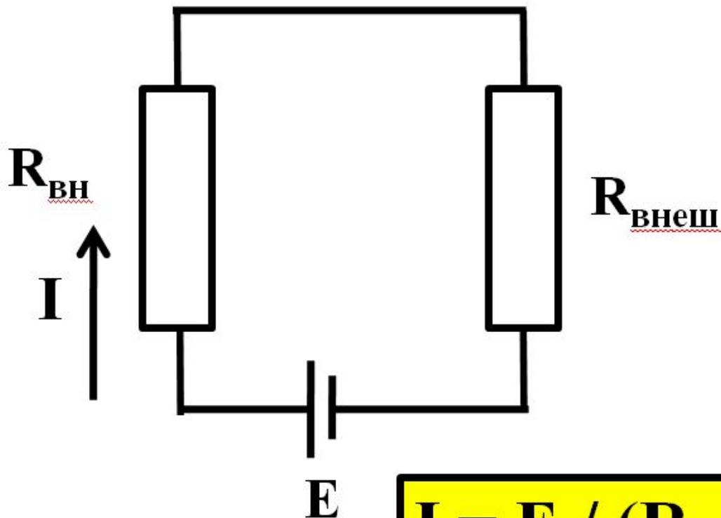
$$I = E / (R_{\text{вн}} + R_{\text{внеш}})$$
