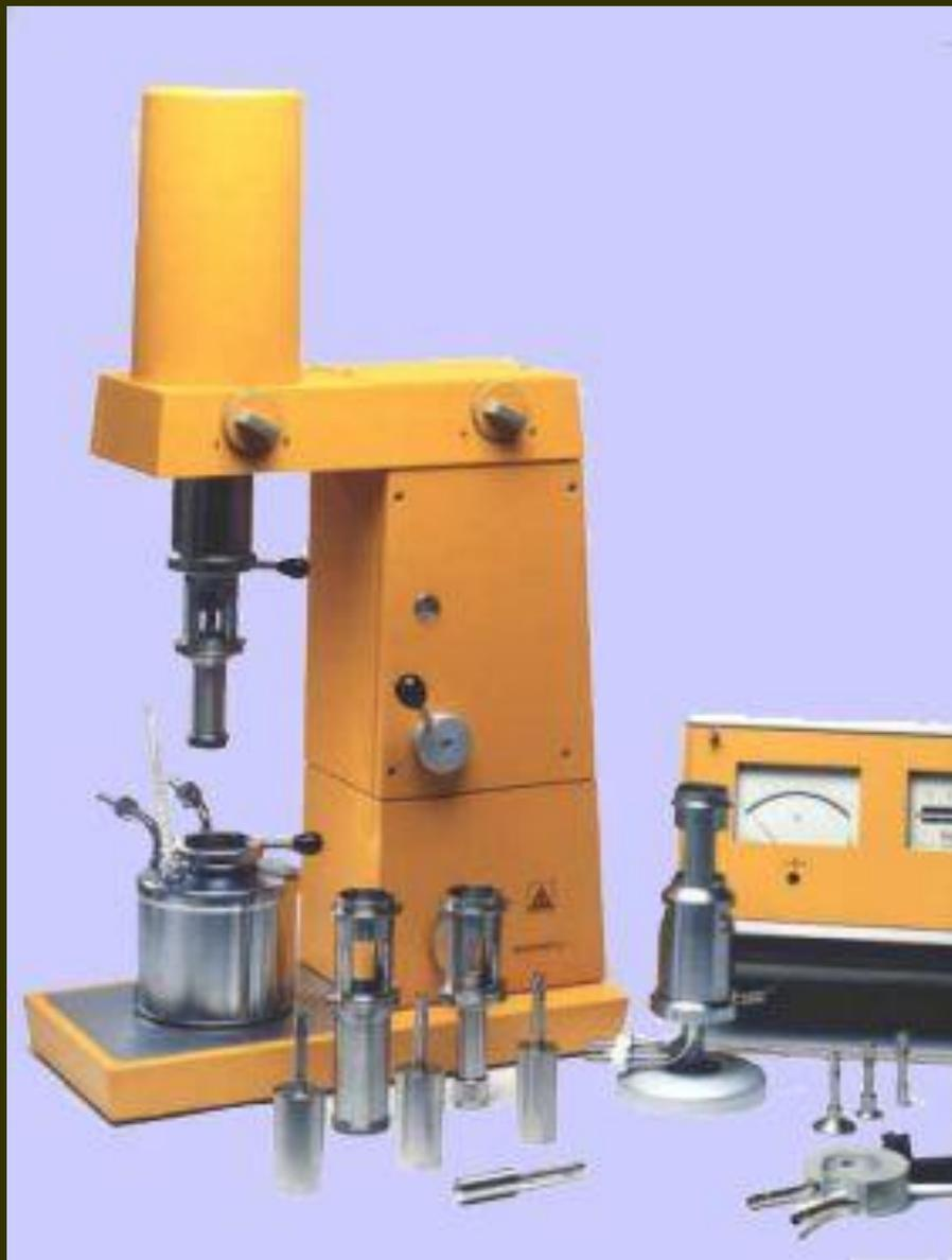
Работает на ротационном принципе измерения, создает заданную скорость сдвига и регистрирует напряжение сдвига.
