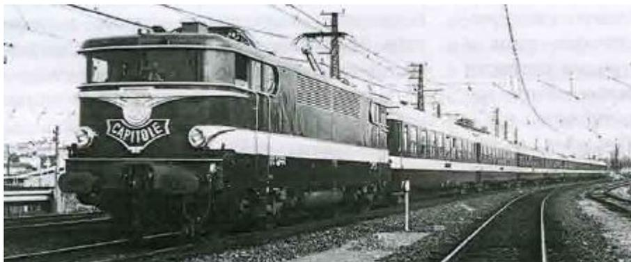
Рисунок – Поезд «Капитоль». Первый в Европе экспресс с максимальной скоростью движения 200 км/ч. (Франция, 1967 г.)
