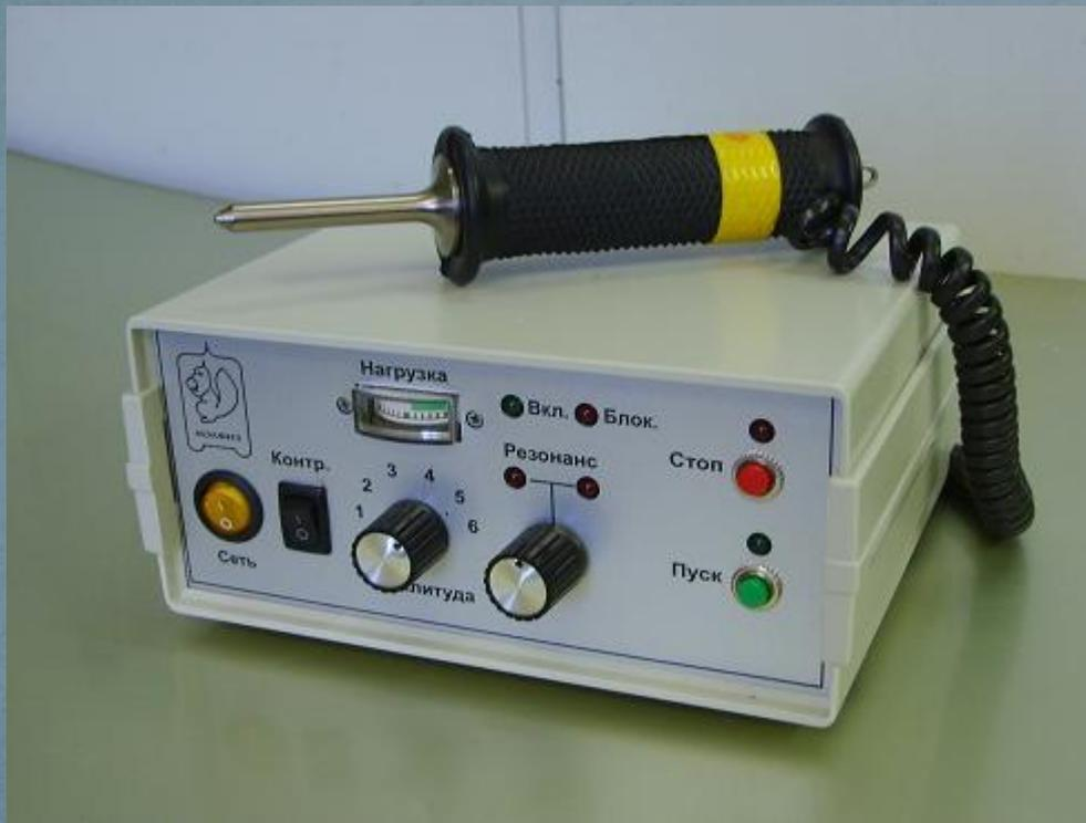
Ручная ультразвуковая установка, применяется для ультразвуковой сварки
