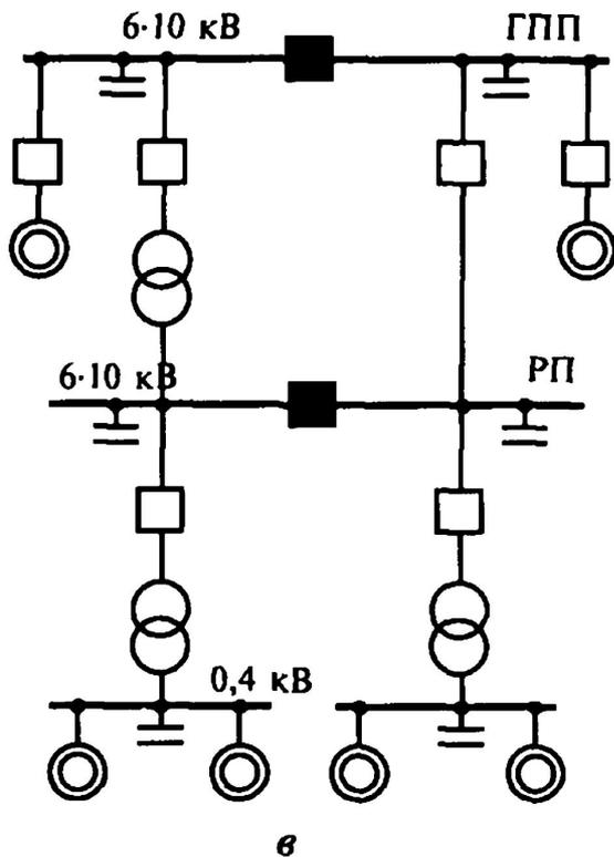
**Рис. 13.7.** Способы компенсации реактивной мощности в сетях промышленных предприятий:
