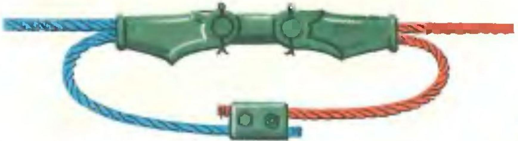
Соединяют двумя клиновыми зажимами с соединительной планкой, концы проводов выступающие из клиновых зажимов, соединяют болтовым зажимом
