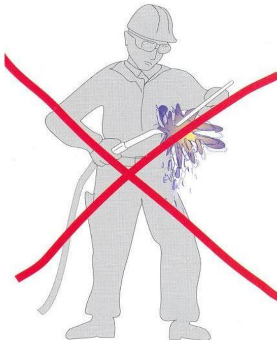
При работах на системе кондиционирования необходимо следить, чтобы в радиусе 5 метров не было смотровых ям, колодцев или входов в подвалы. Следует включить вытяжную установку.
