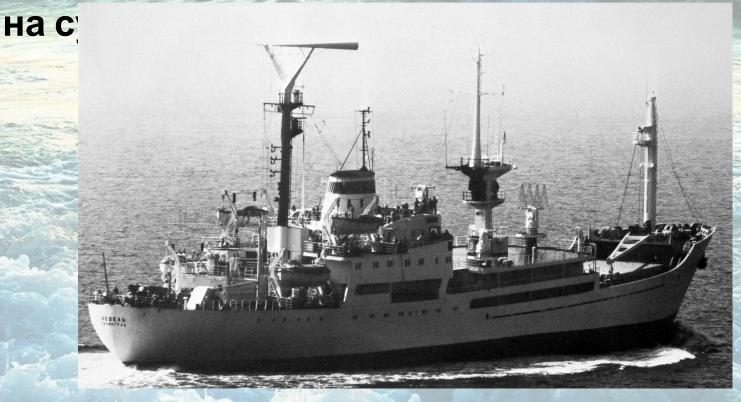
Научно-исследовательское судно "Невель"- одно из серии НИС, построенных в 1967 году. Для выполнения задач экспедиции на борту «Невеля» располагались 12 лабораторий, 3 радиотелеметрические станции, станция космической связи, аппаратура единого времени, приемно-передающий радиоцентр, аппаратура космической навигации «Шлюз», позволяющая с большой точностью определить место нахождения корабля в океане.
