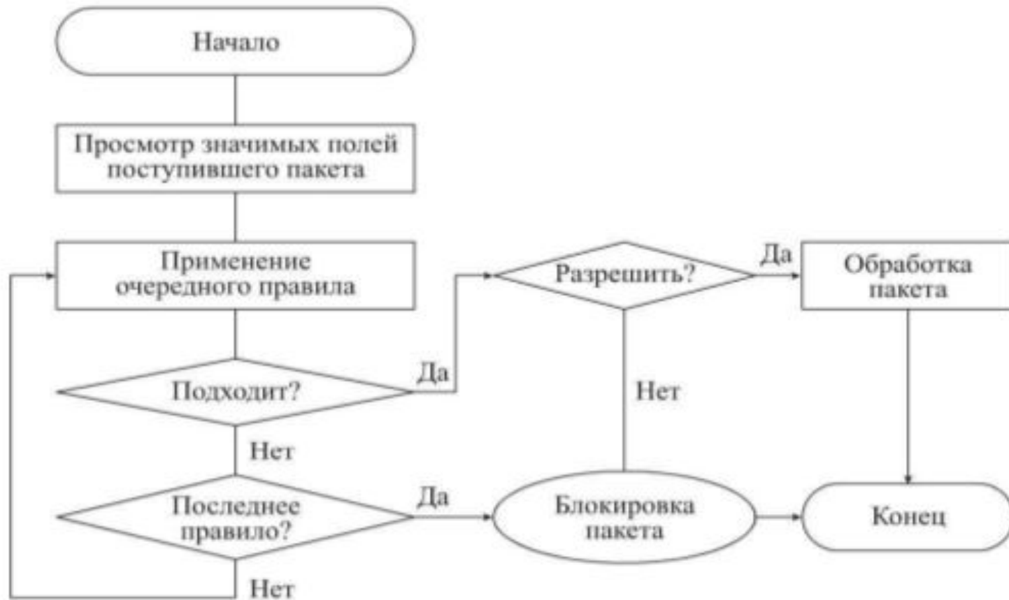
Рис. 7. Алгоритм работы пакетного фильтра
