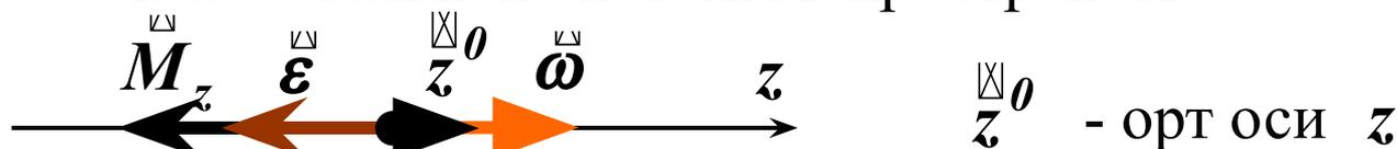
$\vec{\omega}$  - угловая скорость. Вектор  $\vec{\omega}$  направлен вдоль оси вращения так, что образует правый винт с направлением движения маятника.
