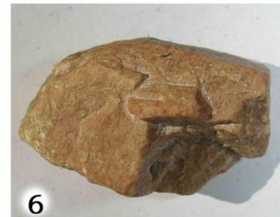
6 ОРТОКЛАЗ царапается напильником
