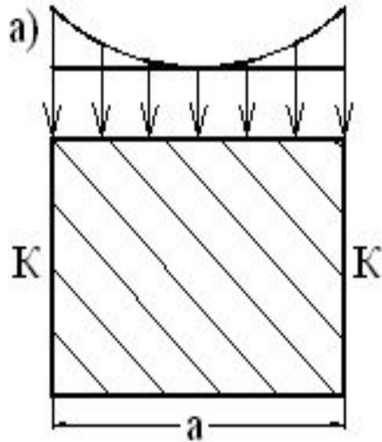
Напряжение в упругой среде, максимальное напряжение на контуре целика.
