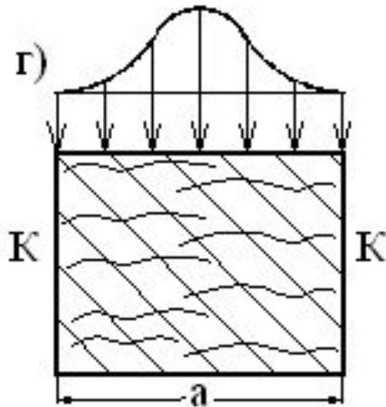
$\gamma_H$  Трещины охватывают весь целик (все сечение).
