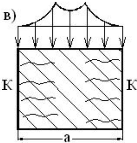
$\gamma_H$  Трещины проникают вглубь массива.
