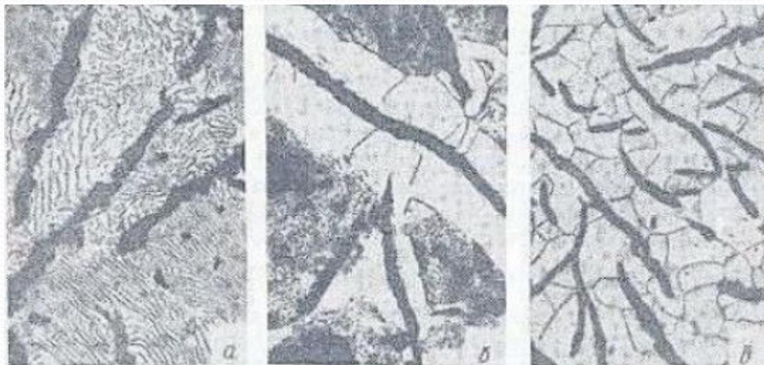
Микроструктура серого чугуна:
