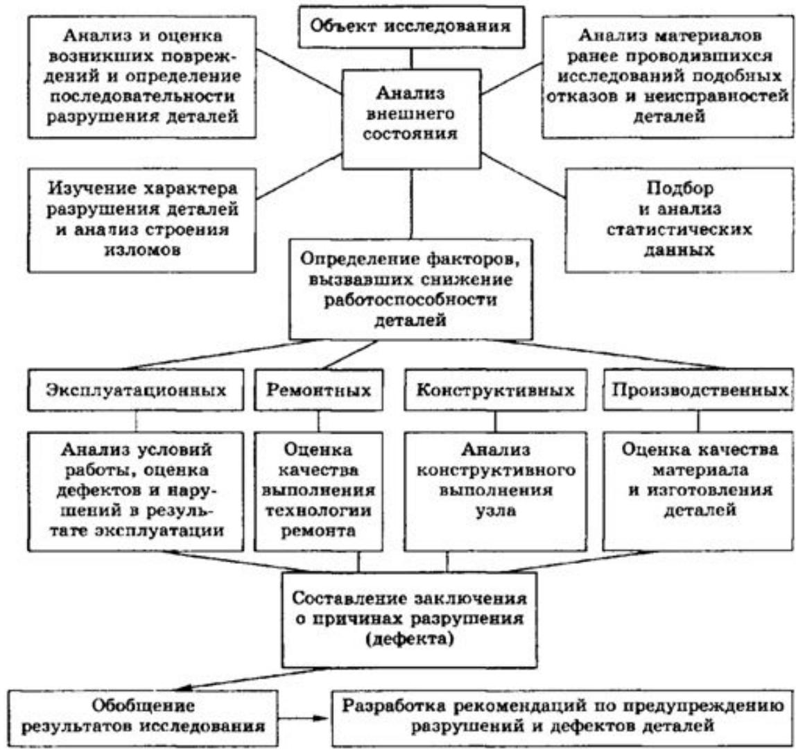
схема проведения исследований по выявлению причин отказов элементов машин
