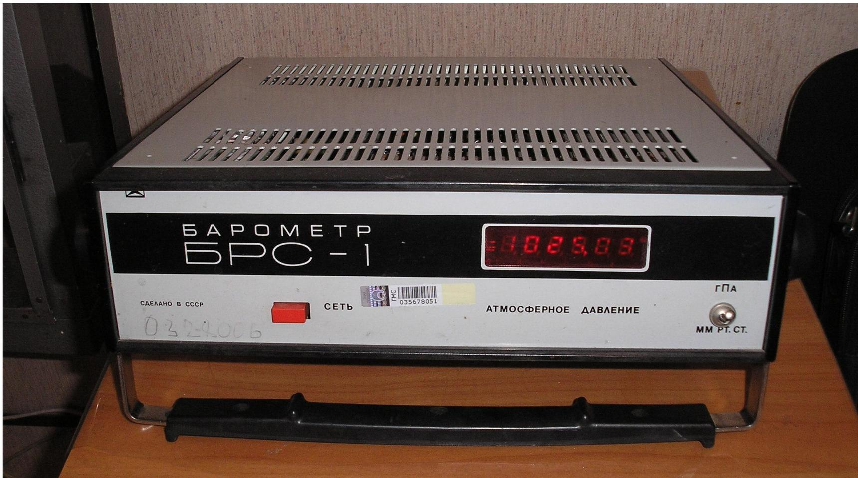
**Рис. 5.6. Внешний вид барометра БРС-1.**
