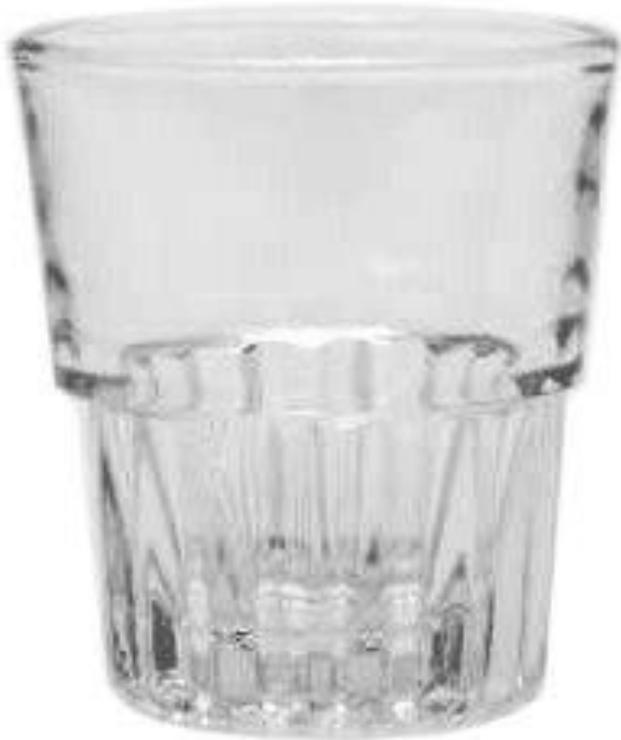
○ Прессовыдувание – сочетает прессование (нижняя часть) и выдувание (верхняя часть). Этим способом получают графины, маслѐнки, бутылки для молочных продуктов.
