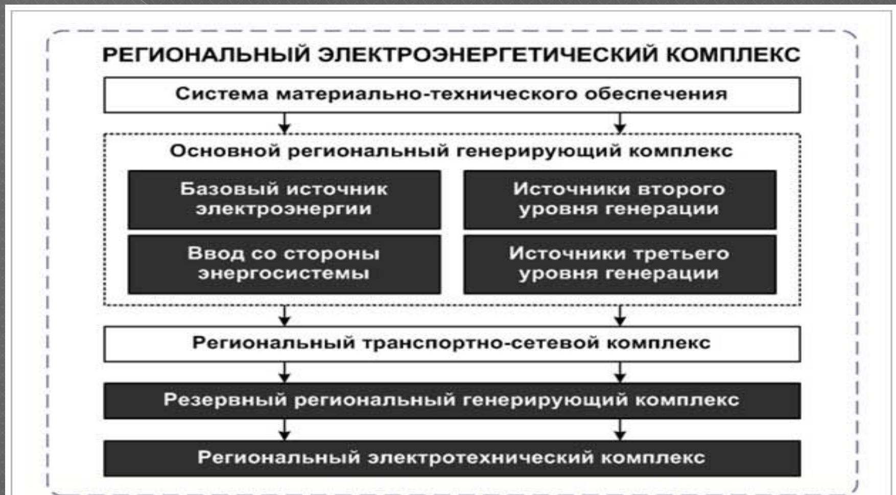
Рис. 1. Основной состав и структура регионального электроэнергетического комплекса
