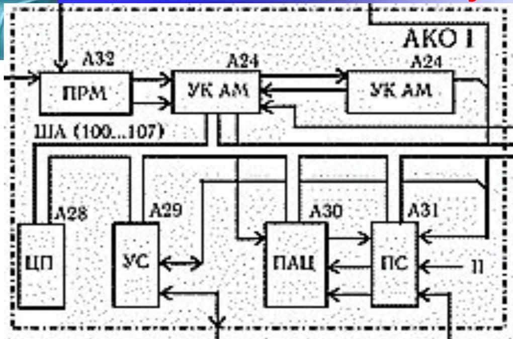
Напряжение **U<sub>изм</sub>**, формируемое в **УКАМ**, а также тест-сигналы с **МАМ**, **АФСМ**, поступающие с преобразователя сигналов (**ПС - А31**), поочередно в соответствии с заданной программой, преобразовываются в преобразователе аналого-цифровом (**ПАЦ- А30**) в цифровой код и через параллельный интерфейс, подключенный к шинам адреса, данных и управления, транслируются в ЦП для окончательной обработки.
