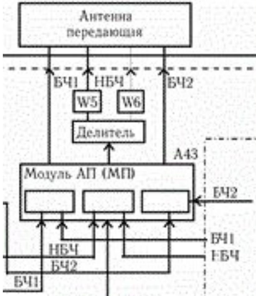
**Устройства согласования W5 и W6** предназначены для согласования выхода МП с ВЧ трактом передающей антенны по каналу НБЧ.
