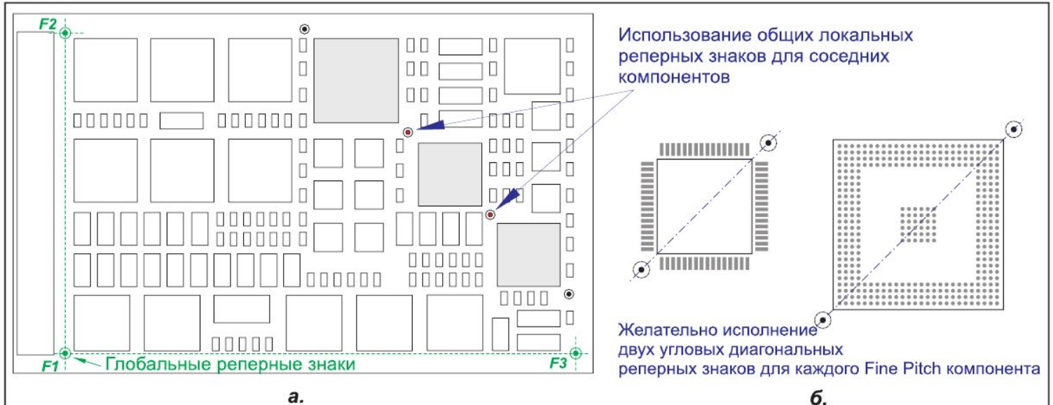
Рис. 8. Принципы расположения реперных знаков: а- размещение глобальных и общих локальных реперных знаков, б - рекомендуемое размещение локальных реперных знаков..
