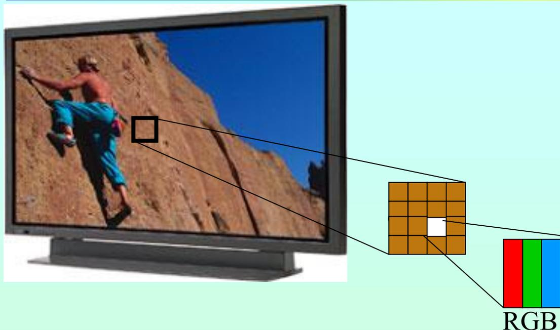
Люминофор покрывает заднюю и частично боковые стенки камеры ячейки. Используются люминофоры трёх разных составов, соответственно, излучающие основные цвета: красный, зелёный, синий.
