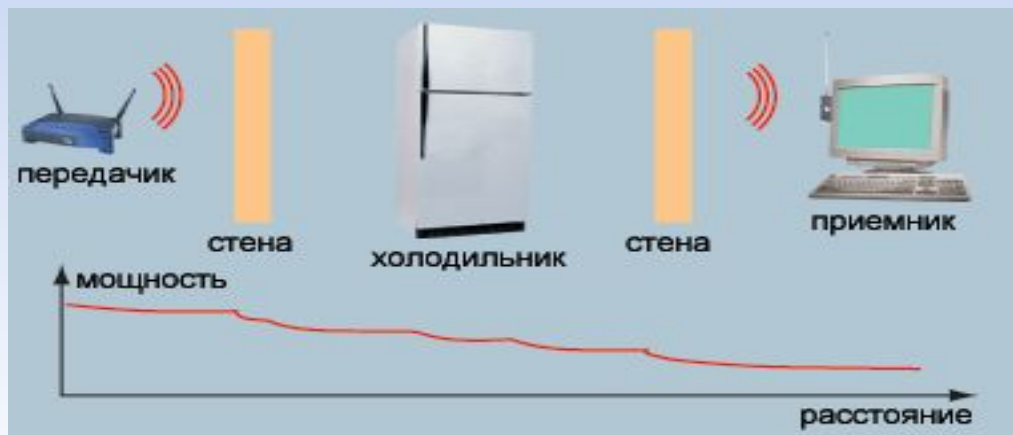
Затухание сигнала в зависимости от расстояния
