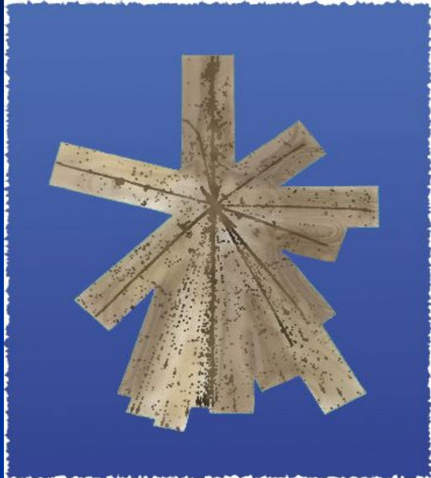
■ Пучок элементарных частиц, пролетая через фотоэмульсионный слой, оставляет следы, которые можно увидеть после проявления пленки. Анализируя траектории этих следов, можно судить о видах частиц, которые содержатся в пучке.
