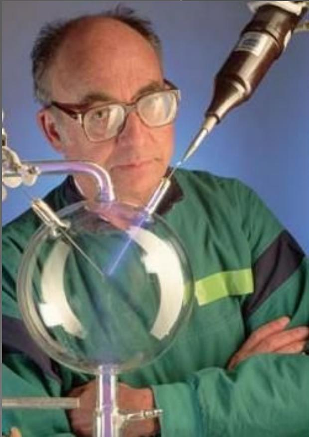
**Впервые в 1953 г. С. Миллер (США) создал достаточно простую установку, на которой ему удалось из смеси газов и паров воды под действием ультрафиолетового облучения и электрических разрядов синтезировать ряд аминокислот и других органических соединений**
