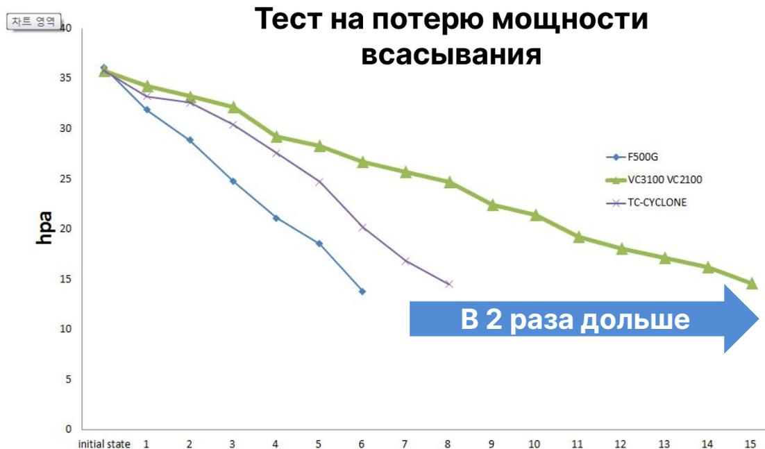
На основании внутреннего тестирования. Испытано с турбинным вентилятором с использованием смеси волос и шерсть домашних животных на полу. Проверено на Samsung VC5100 и Samsung VC21F50UKGC / EN. База по результатам внутреннего тестирования
