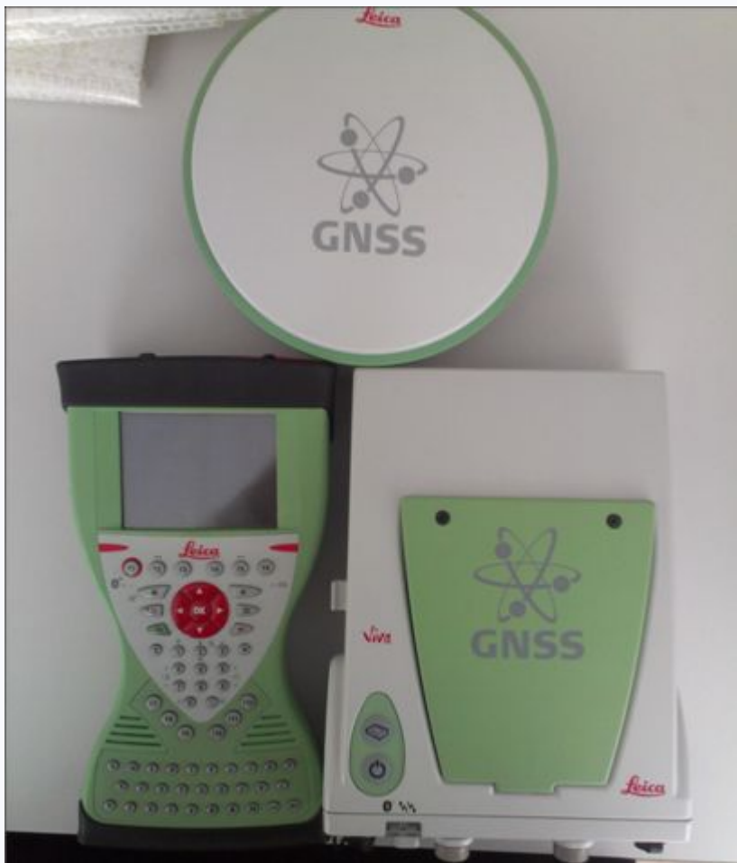
Антенна Leica AS10, контроллер, GNSS-приемник модели Leica GS10
