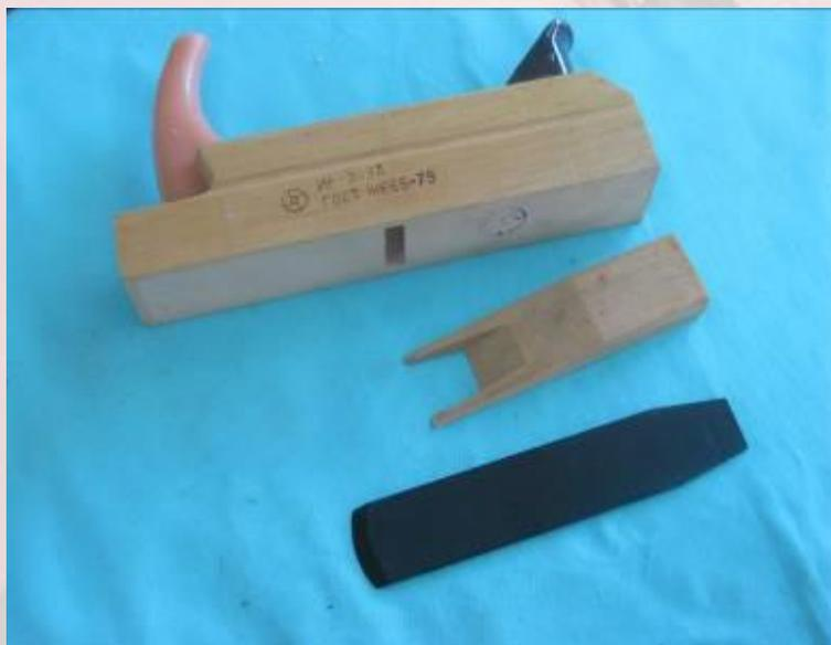
**Рубанок** имеет колодку шире, чем шерхебель. Ширина железки 45-50 мм. Форма ножа рубанка прямая. Он применяется для чистового строгания.
