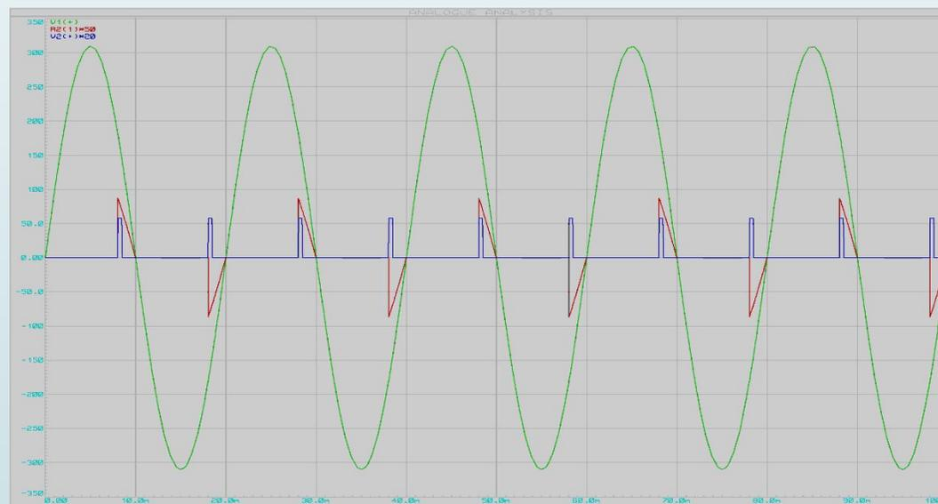
Временные диаграммы работы блока гальванической развязки
