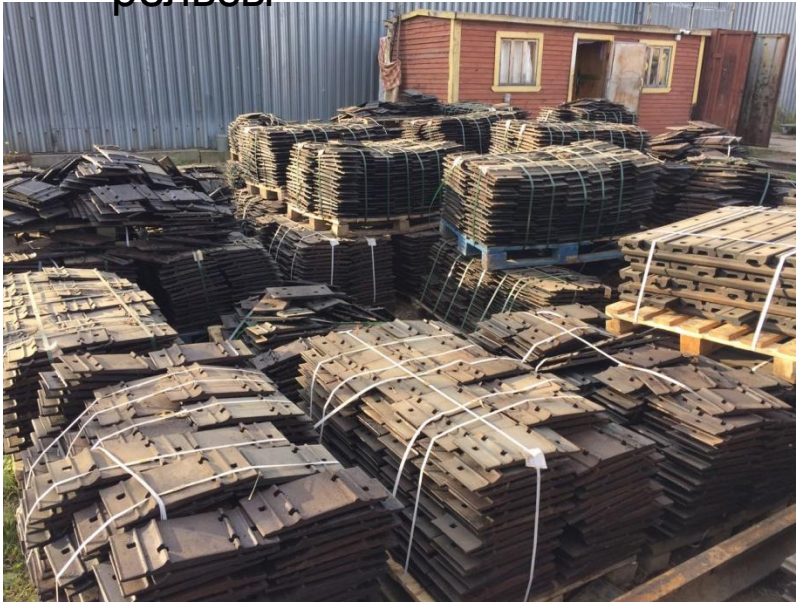
Подкладки под рельсы
