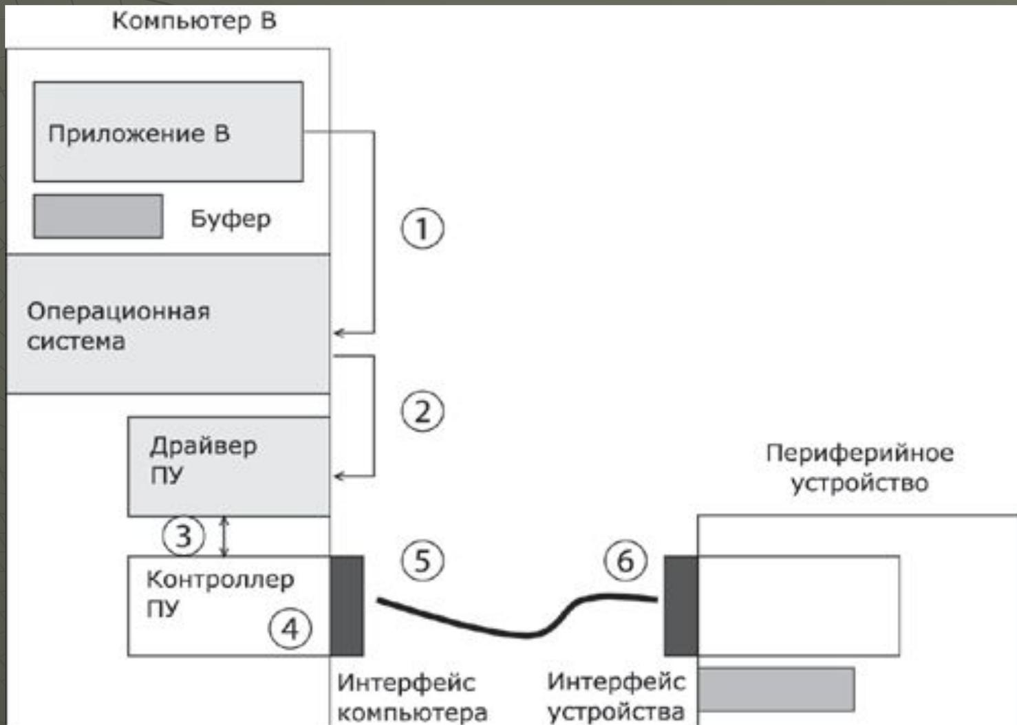
Обмен данными между ПУ и компьютером, как правило, является двунаправленным. Так, например, даже принтер, который представляет собой устройство вывода информации, возвращает в компьютер данные о своем состоянии.
