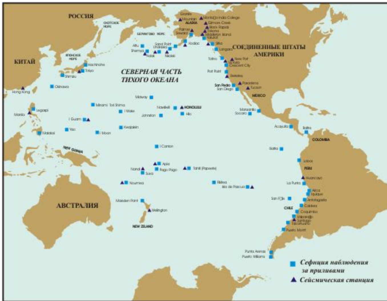
Сейсмические станции и станции наблюдения за приливами. Системы предупреждения о цунами в Тихоокеанском регионе
