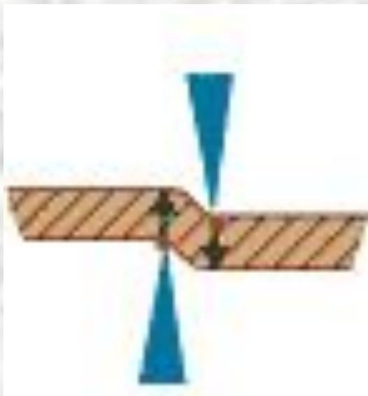
**Деформации сдвига** подвержены все балки в местах опор, заклёпки и болты, скрепляющие детали и т.д. Сдвиг на большие углы может привести к разрушению тела - срезу. Срез происходит при работе ножниц, долота, зубила, зубьев пилы.
