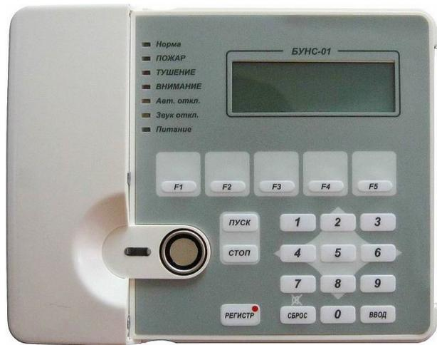
ППКПУ серии «Водолей» предназначен для организации на объекте системы адресной пожарной сигнализации с водяным или пенным пожаротушением
