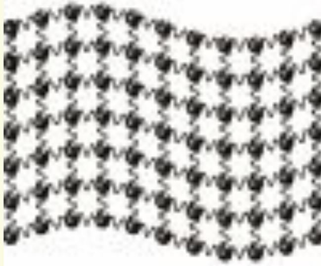
Поперечная волна в сетке, состоящей из шариков, скреплённых пружинками. Колебания масс происходят перпендикулярно направлению распространения волны.
