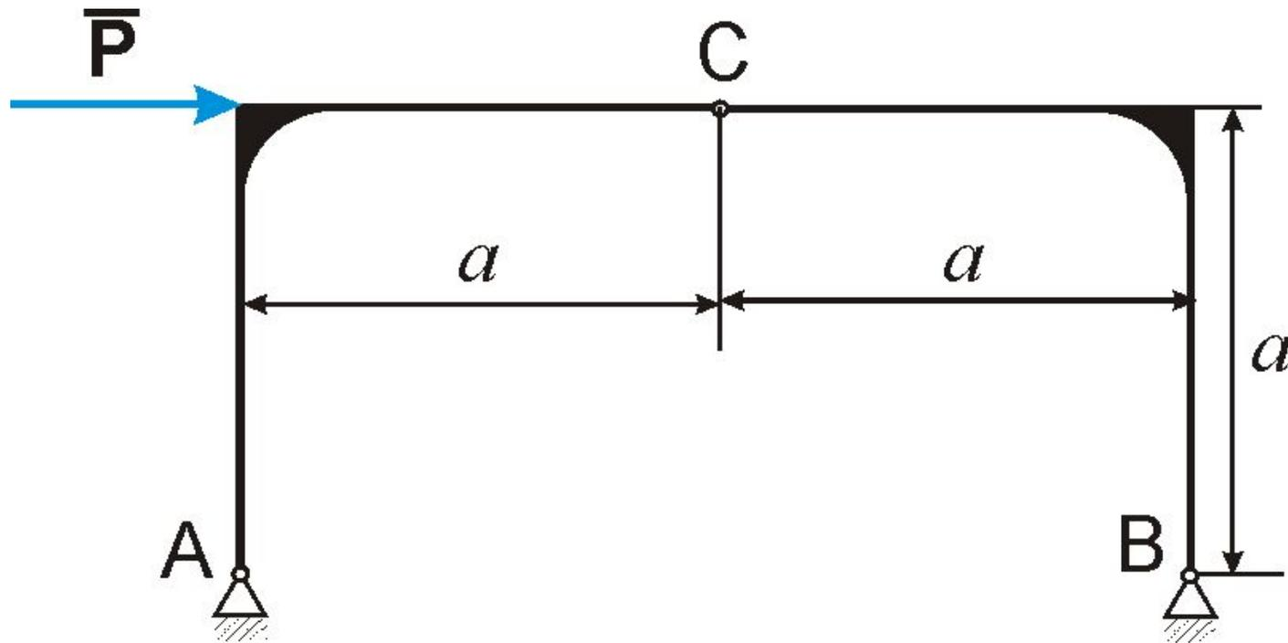
*Для трехшарнирной арки, показанной на рисунке, определить реакции опор  $A$  и  $B$ , возникающие при действии горизонтальной силы  $P$ . Весом арки пренебречь.*
