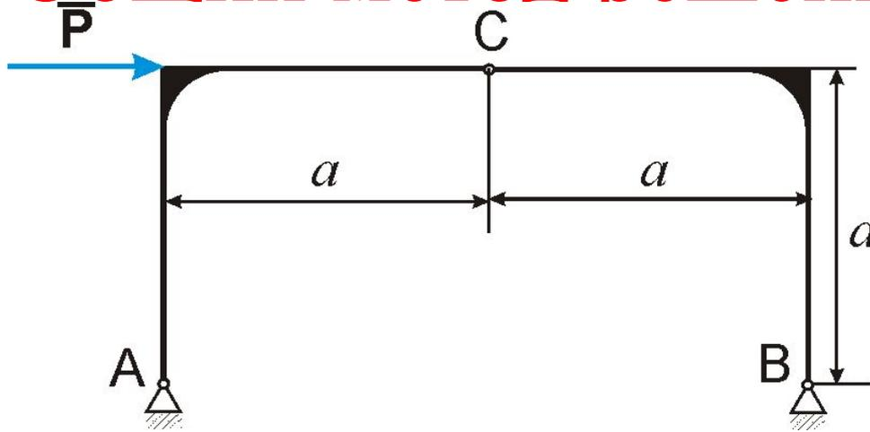
• Систему тел разделяют на отдельные элементы (тела) и для каждого составляют уравнения равновесия. При этом влияние тел друг на друга учитывают через силы, действующие в местах разделения системы.
