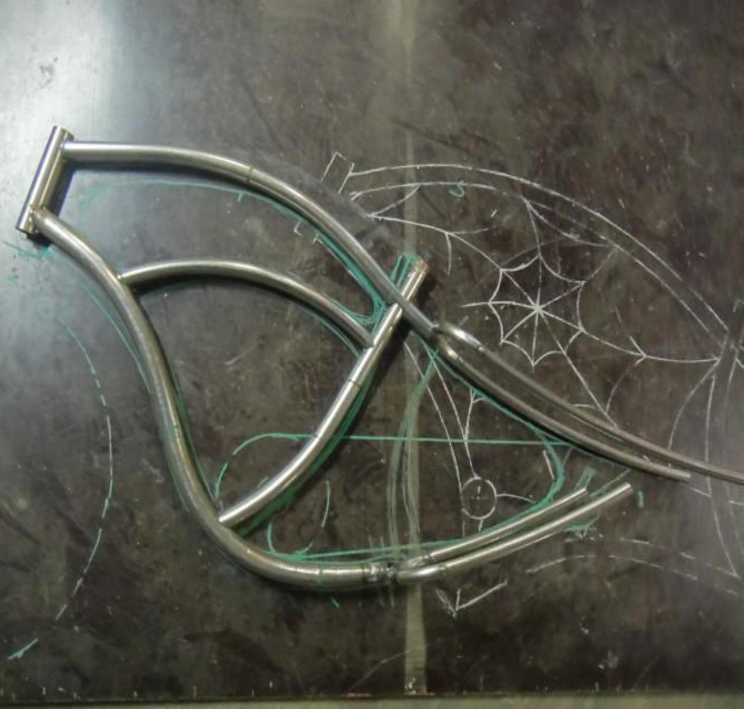
На следующем этапе была произведена сборка данной конструкции все элементы собирал при помощи прихваток.
