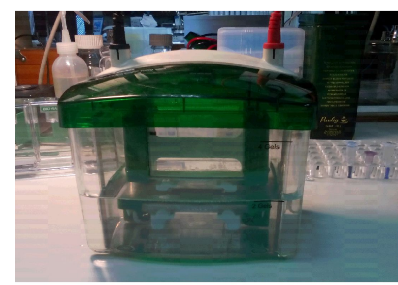
Рис. 9. Заполненная камера для электрофореза с подключением к ней источником тока
