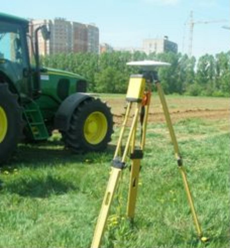
**Спутниковая антенна управления техникой при выполнении технологических агроприемов точного земледелия**
