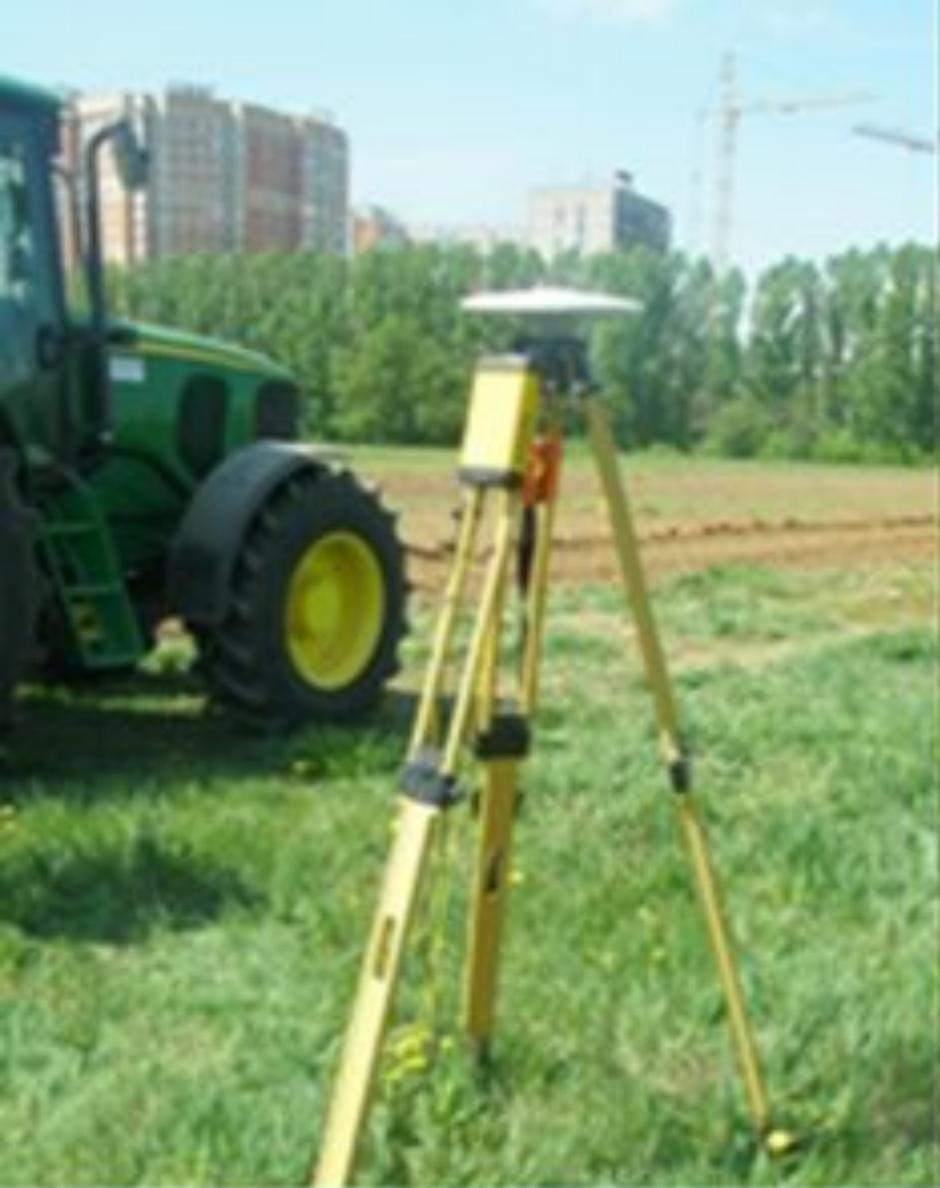
**Фото 1. Спутниковая антенна
