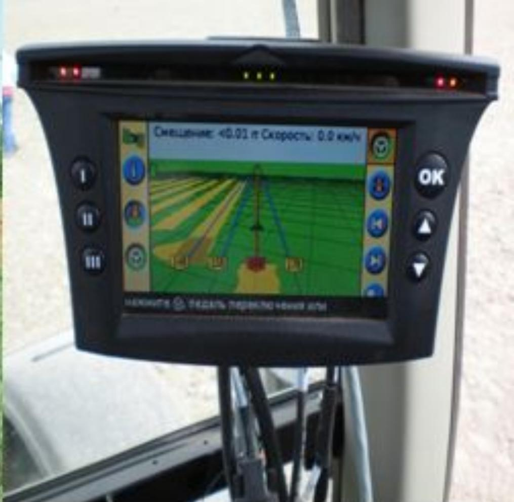
**Компьютерное управление при выполнении технологии точного земледелия**
