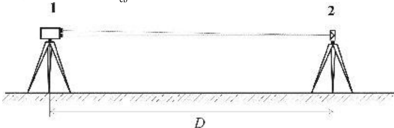
Рис.6. Схема определения неприступного расстояния светодальномером
