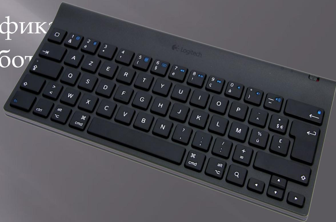
**Клавиатура-Устройство, которое используется для ввода данных (букв, цифр и других символов) в компьютер. Клавиатура является составной частью компьютера и используется для управления им – при помощи особых клавиш.**
