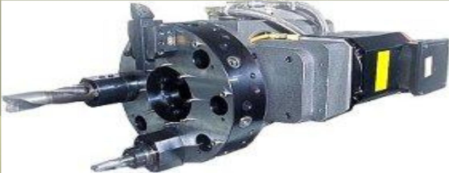
Станок оснащен револьверной головкой.
