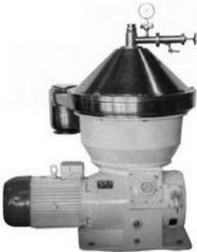
Сепарирование идет в специальных машинах — сепараторах.
