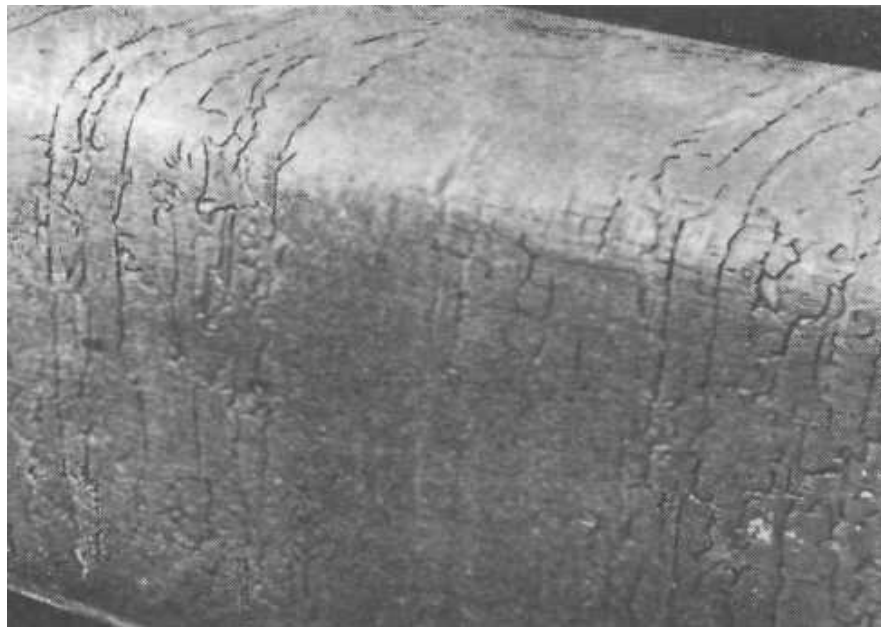
Внешний вид слитка стали 12Х18Н10Т с заворотами корок на поверхности
