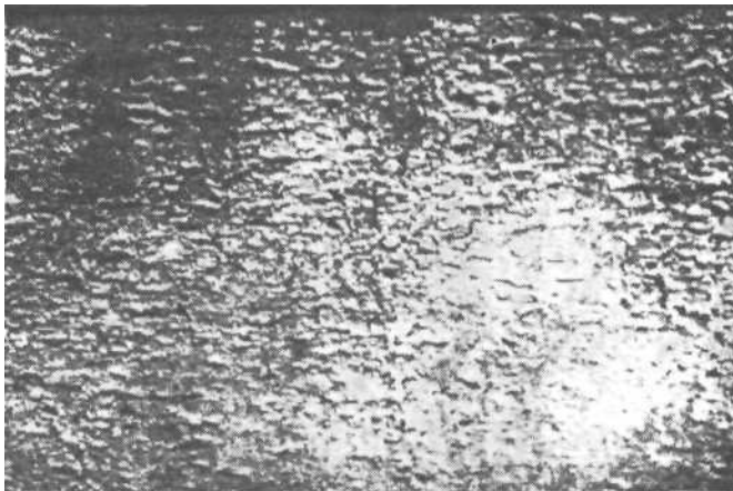
Поверхность прутка с рябизной
