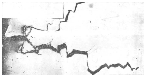
Микрошлиф сплава ХН68ВКТЮ с шлифовочной трещиной
