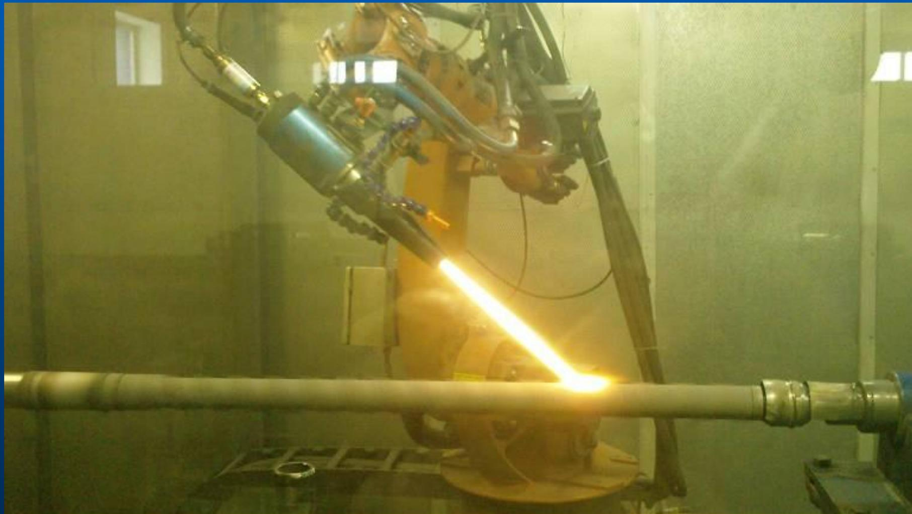
Восстановление с упрочнением штоков телескопического гидроцилиндра ООО «Стройгазмонтаж-Сервис, г. Оренбург. Восстановление произведено в 2009 году методом высокоскоростного напыления материала системы Ni-Cr-B-C, HRc 56.
