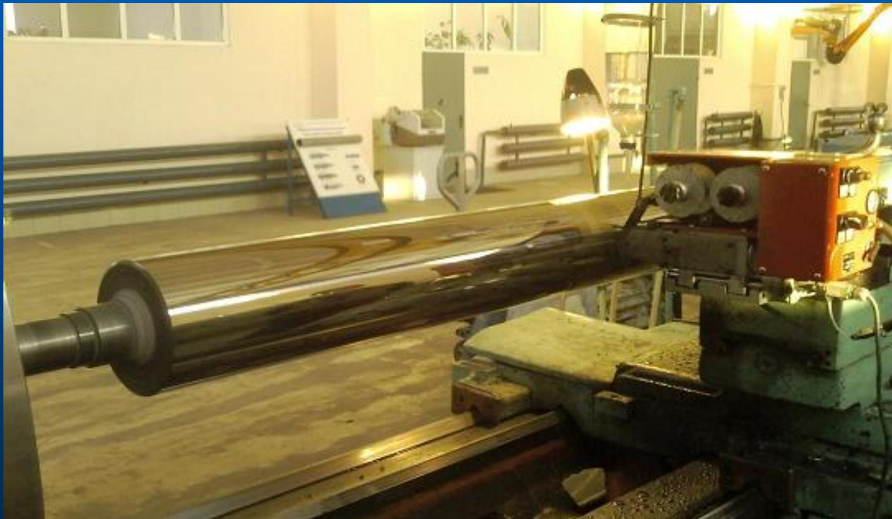
Выкрашивание металла на валу каландра машины производства полимерных волокон ООО «Си-Айрлайд», г. Челябинск. Вал восстановлен наплавкой поврежденной зоны с последующим напылением карбида хрома HRC 70 высокоскоростным методом.
