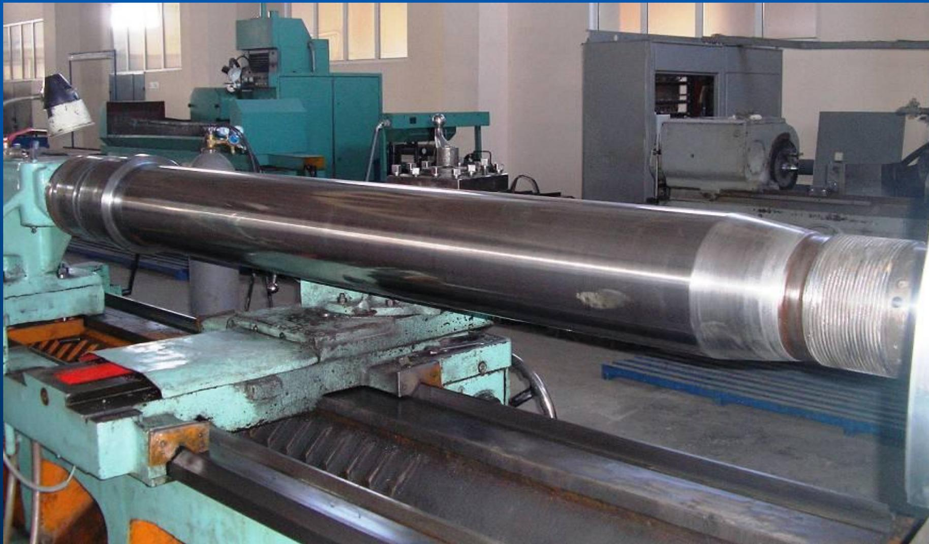
Упрочнение витков шнека Уфимского завода эластомерных материалов и конструкций методом высокоскоростного напыления карбидом вольфрама. Шнек эксплуатируется с 2010 года.
