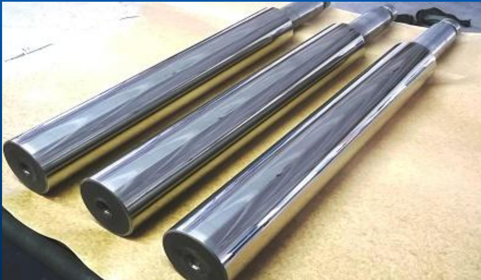
Износ плунжеров триплекс-насоса «Uraca» ОАО «Газпром нефтехим Салават», перекачивающих аммиак с рабочим давлением 200 атм.
