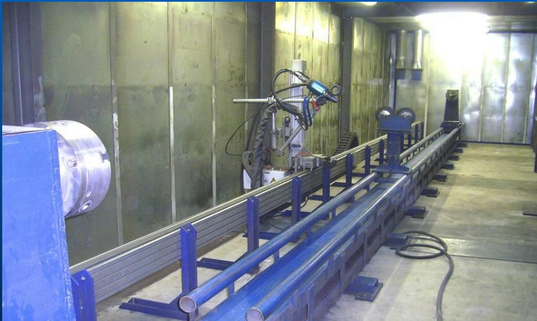
Рабочее место оператора установки высокоскоростного напыления. Процесс напыления управляется компьютером.
