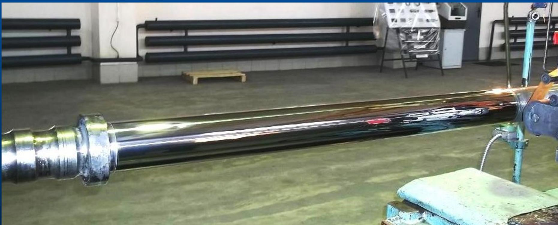
Плунжера импортного триплекс - насоса Ишимбайского химического завода катализаторов с поврежденным керамическим покрытием под восстановление.
