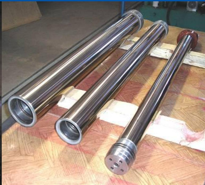
Полировка вала каландра листовальной машины производства полистирольного листа ООО «Урал-Пласт», г. Магнитогорск, восстановленного методом высокоскоростного напыления карбида вольфрама, HRC 74, 2011 год.
