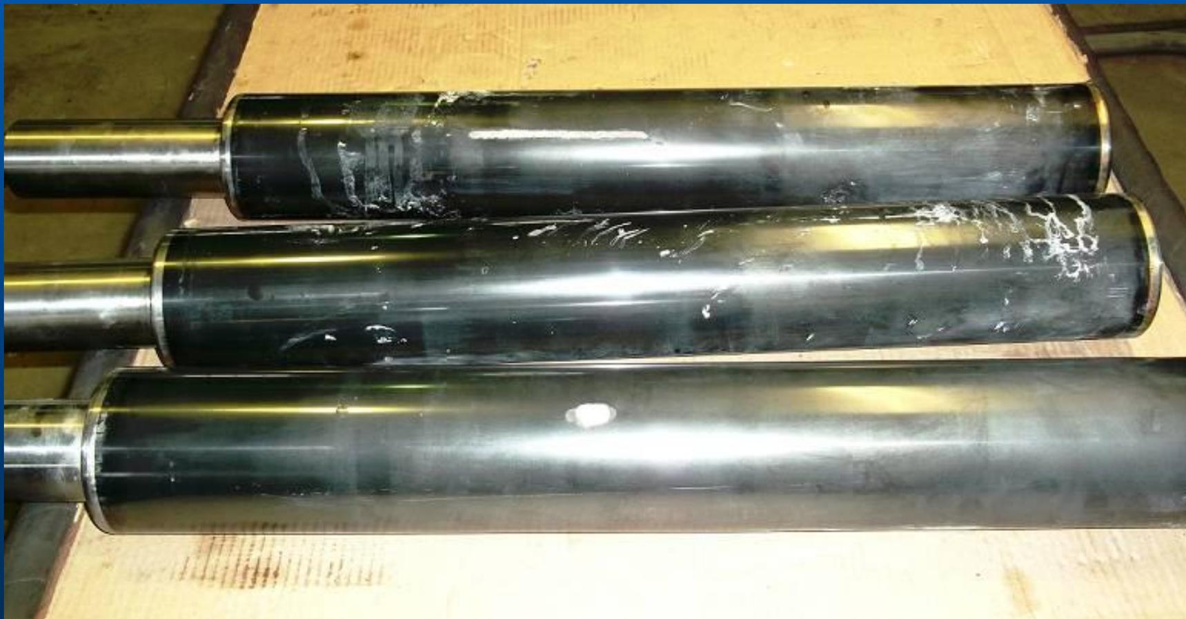
Плунжера триплекс - насоса Ишимбайского химического завода катализаторов, восстановленные высокоскоростным напылением карбидом хрома.
