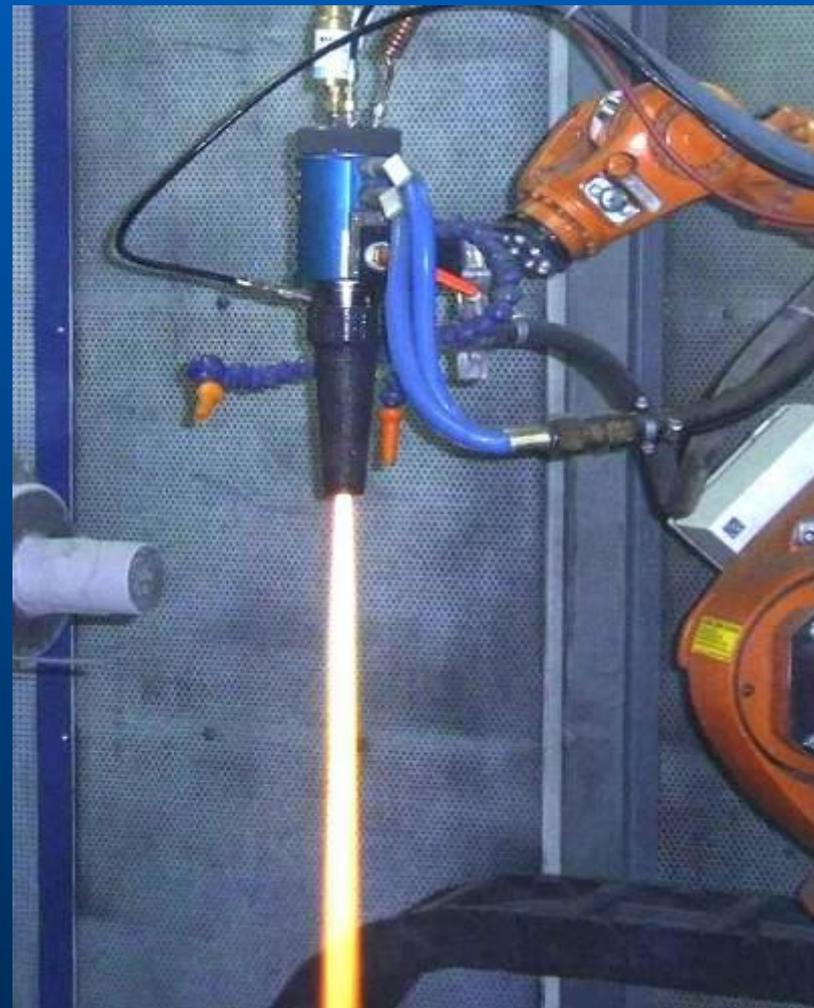
Большая камера высокоскоростного напыления.
