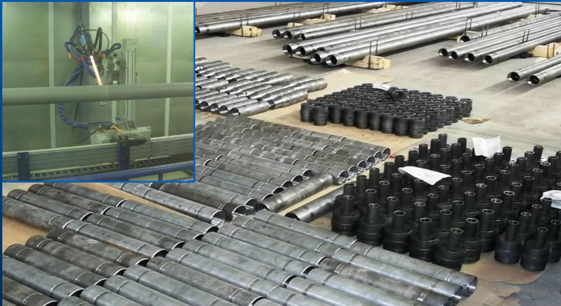
Защита от коррозии корпусов и концевых деталей УЭЦН, предназначенных для работы в скважинах с агрессивной средой, методом высокоскоростного напыления стали X28H16M5C1, HRC 54
