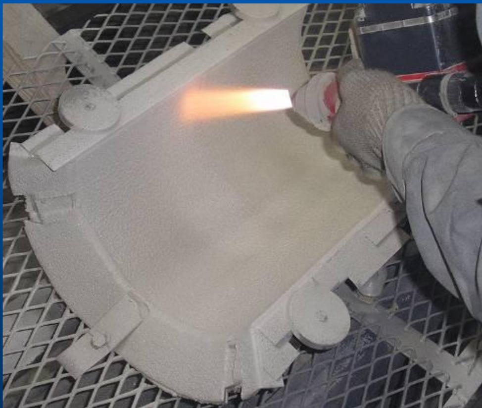
Напыленный баббитовый слой имеет пористую структуру, которая позволяет производить пропитку баббитового слоя маслом. В результате этого отсутствует режим сухого трения при пуске компрессора, до выхода на обороты, при которых начинает работать масляный клин.
