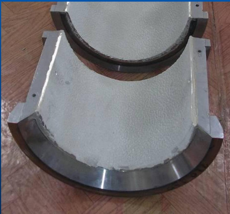
Улучшение условий смазки в узле трения и особая структура напыленного баббита увеличивают ресурс работы напыленного подшипника более, чем в 2 раза, по сравнению с подшипником, наплавленным баббитом.
