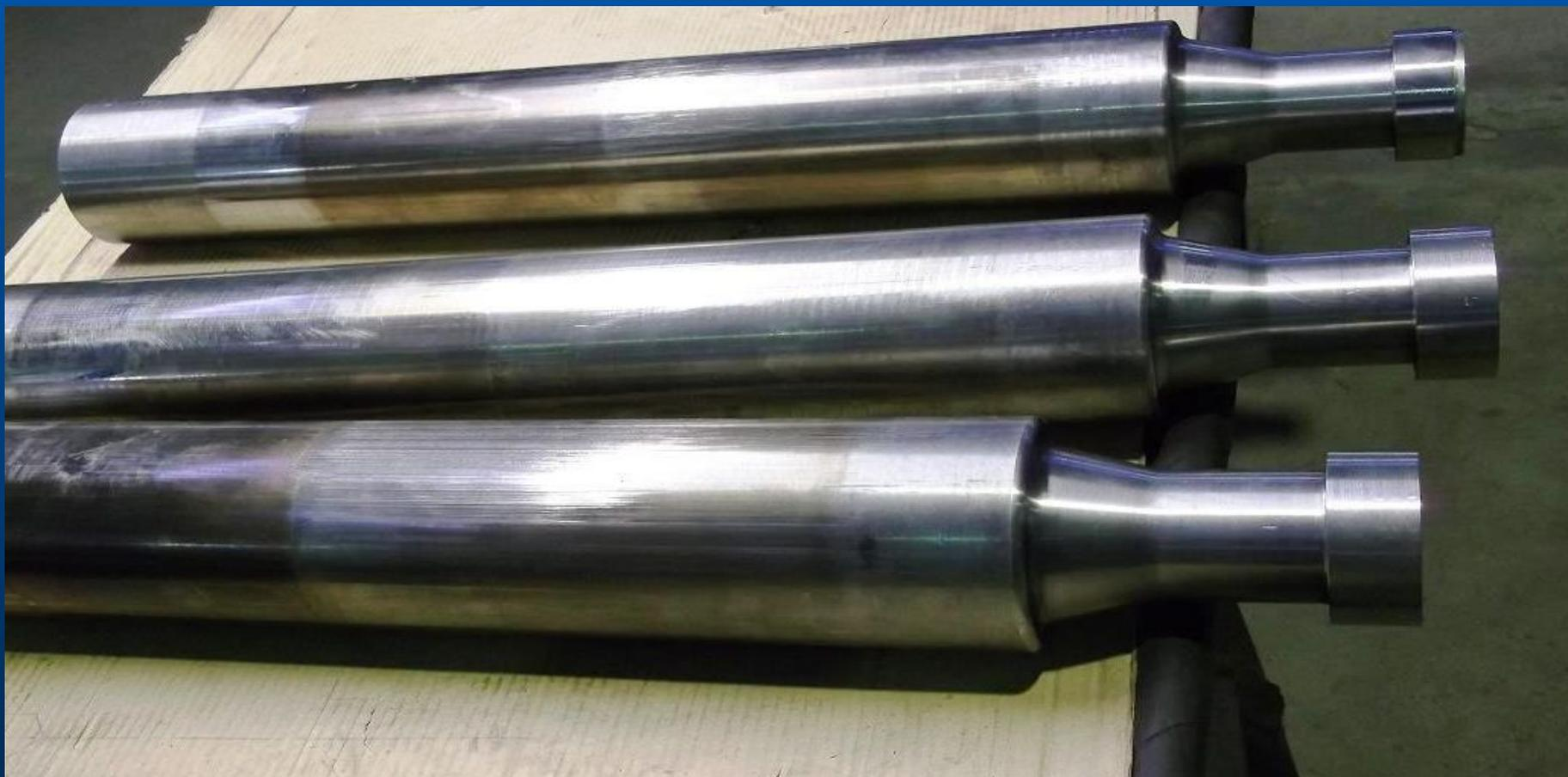
Метод высокоскоростного напыления позволяет восстанавливать и упрочнять плунжера триплекс - насосов.
