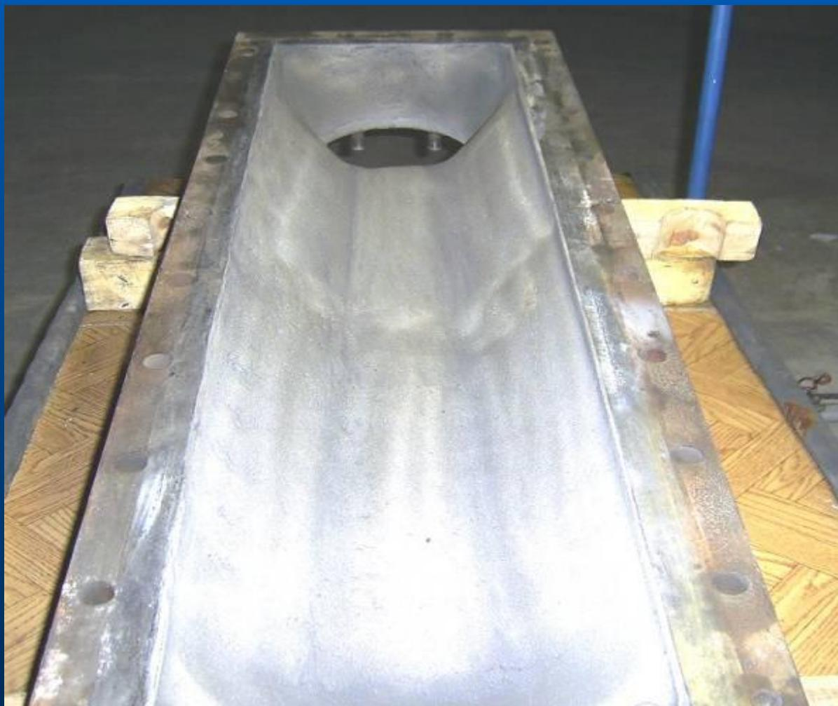
Защита от коррозии корпусов и концевых деталей УЭЦН по заказам ОАО «БЭНЗ», предназначенных для работы в скважинах с агрессивной средой ОАО «Самаранефтегаз», ОАО «Башнефть», методом высокоскоростного напыления стали X28H16M5C1, HRC 54
