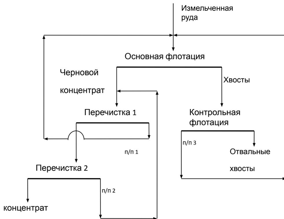
Рис. 11.4 Схема флотационного процесса
