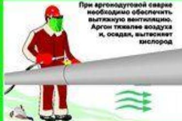
При аргодуговой сварке необходимо обеспечить вытяжную вентиляцию. Аргон тяжелее воздуха и, оседая, вытесняет кислород
