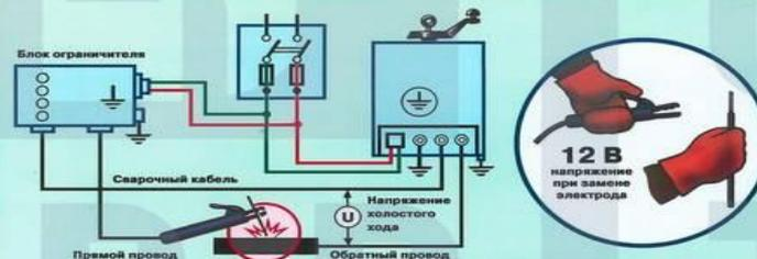
При работе в особо опасных условиях (резервуары, колодцах, котлах, тоннелях и т.п.), а также при повышенной влажности используйте ограничитель напряжения холостого хода
