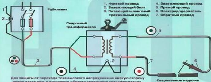
Для защиты от перепада тока высокого напряжения на низкую сторону нужно заземлить и вторичную обмотку сварочного трансформатора.
