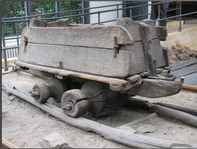
Шахтный деревянный рельсовый путь и вагонетка, Германия, XVI век.
