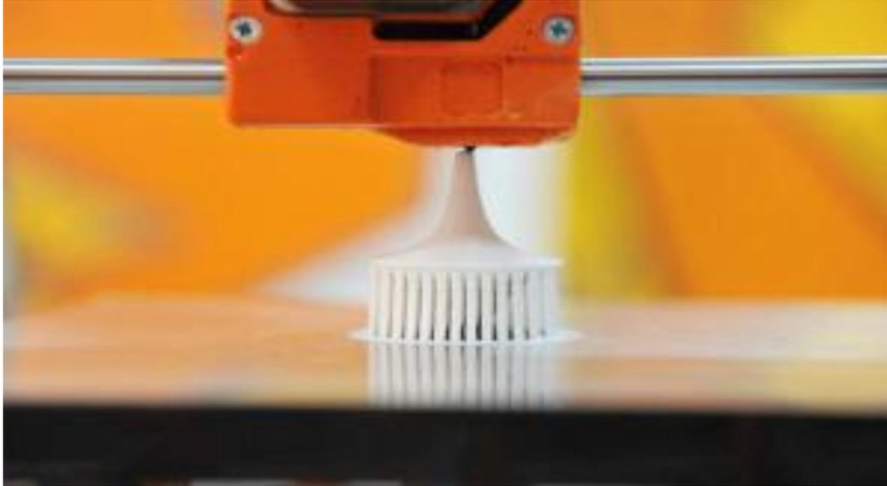
3D принтер – это устройство для создания физических объектов путем последовательного накладывания слоев. Другими словами 3D принтер способен распечатать любой физический предмет, который смоделирован на ПК.
