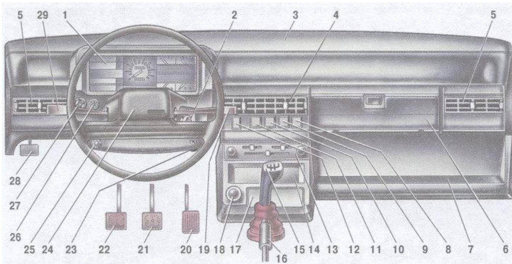
**Рис. 1.8. Комбинация приборов на «низкой» панели**
