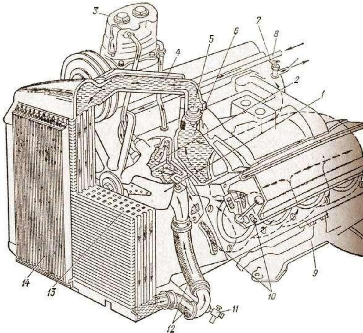
Система охлаждения двигателя КамАЗ
